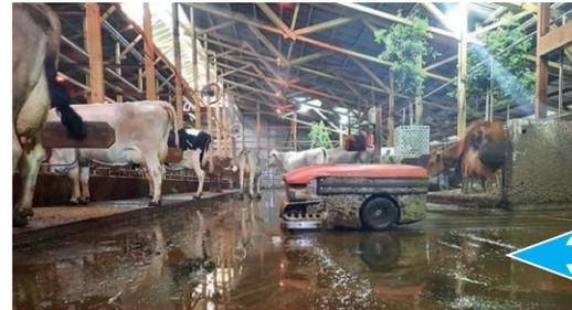
Ausgangspunkt: Laufstall mit planbefestigten Flächen und Liegeboxen, Mistschieber, Vorrube für tagesfrische Gülle (weniger Ammoniak im Stall)
