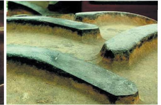
Zwei Beispiele für eine fehlerhafte Spureinstellung. Die Ursache dafür ist in vielen Fällen die sogenannte Vorspur. Bei einer Vorspur stehen die Vorderäder in Fahrtrichtung gesehen nach vorne zusammen.
